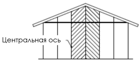
Вертикальный монтаж: две панели по центральной оси
